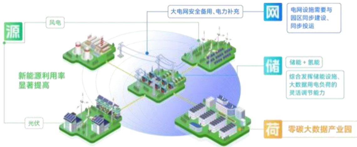
图 1 源网荷储一体化绿色综合供电方案
